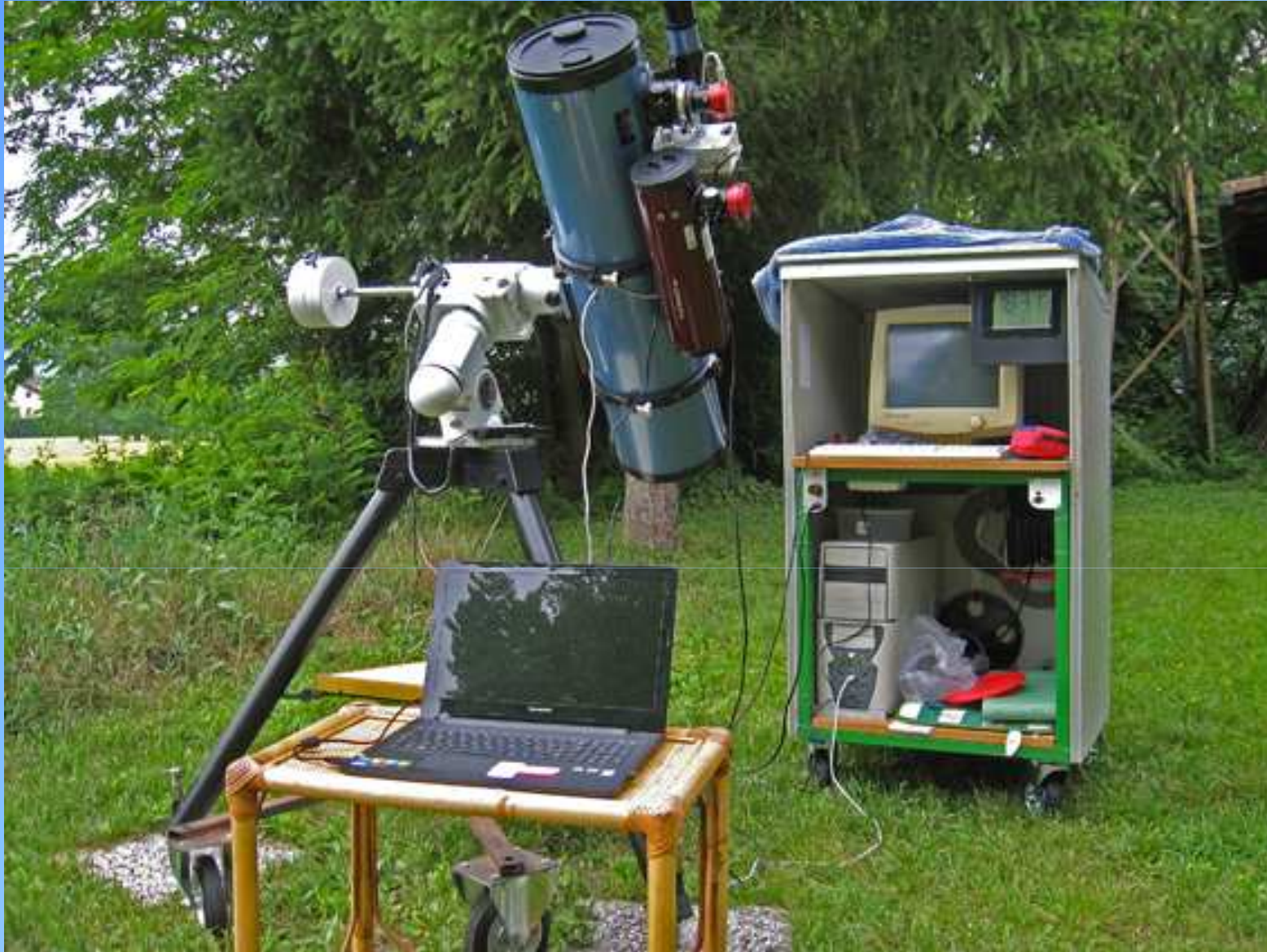
La strumentazione usata da Bruno Cantarella e Luigi Zanatta (Melazzo, Alessandria) per la registrazione del flash da Impatto, Newton 200/1000 e 100/400 con videocamera ASI 120MM.
