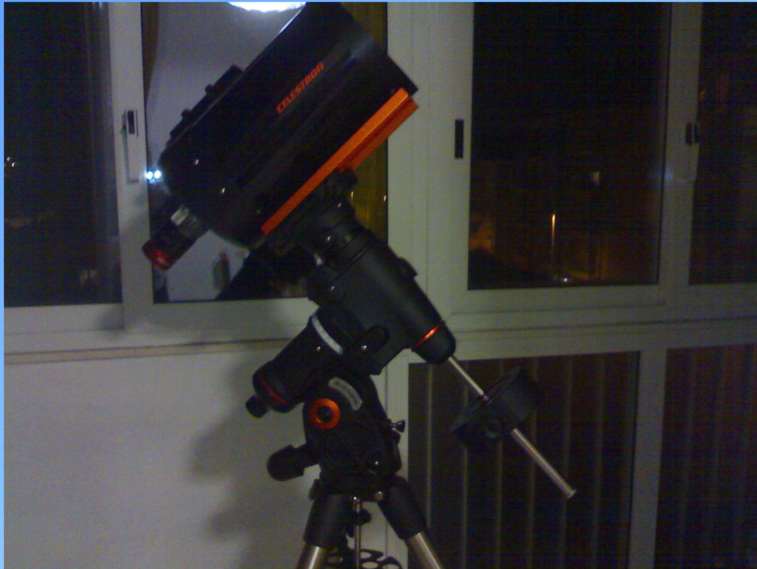
Telescopio Celestron C8 con riduttore di focale della Optec (USA) mod. NextGEN MAXfield 0,33X, videocamera ASI 120MM su montatura CGEM Celestron (strumentazione dell'autore).
